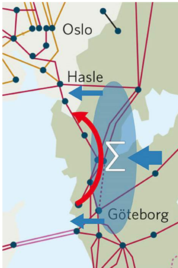
Figur 38 En illustration av förslag om summaallokering. Vid import till SE3 på någon av förbindelserna SE3-DK1 eller SE3-NO1 ökar exportmöjligheterna på den andra. Observera att föreslagen summaallokering inte påverkar tillåtna flöden/kapaciteter i riktning österut. Källa: Svenska kraftnät.
